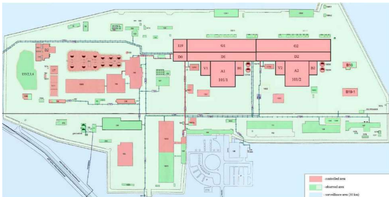
Рисунок 2.2-3. Схема расположения зданий на площадке ИАЭС. Здания, отнесённые к контролируемой зоне, выделены красным цветом. Остальные здания и территория площадки отнесены к зоне наблюдения (выделены зелёным цветом)
