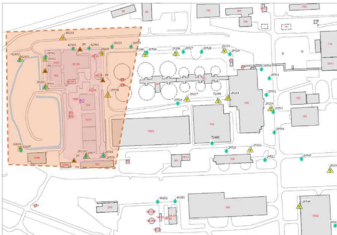
Рисунок 4.1-3. Участок площадки АЭС ИНП, где в 2010-2024 годах было зафиксировано повышенное объемное содержание трития в воде мониторинговых скважин (отмечено розовым цветом).
